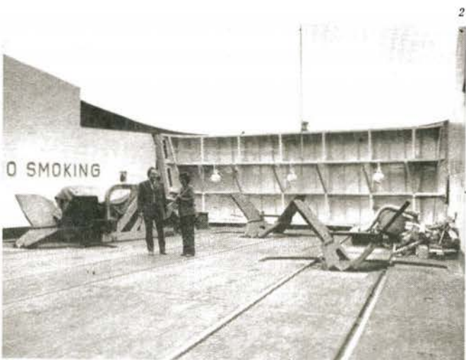
Bild 4 Die tonnenförmig verpackten, sich automatisch aufblasenden Rettungsflöße für je 20 Personen
