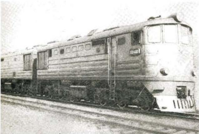
Bild 6 3000 PS dieselelektrische Lokomotive Baureihe TE 10
