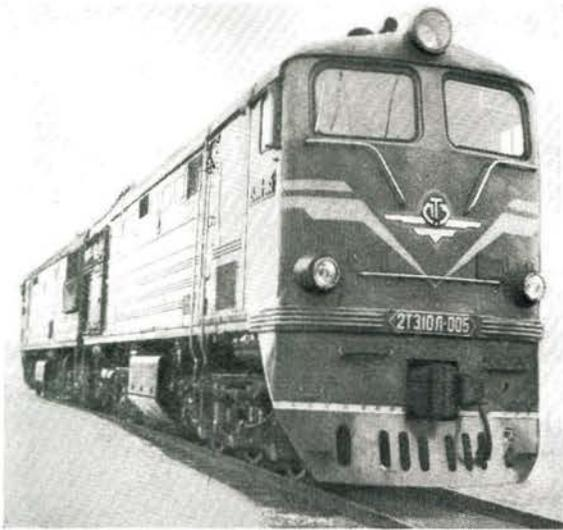
Bild 7 Zweisektionslokomotive Baureihe 2 TE 10 L, 6000 PS, dieselelektrisch
