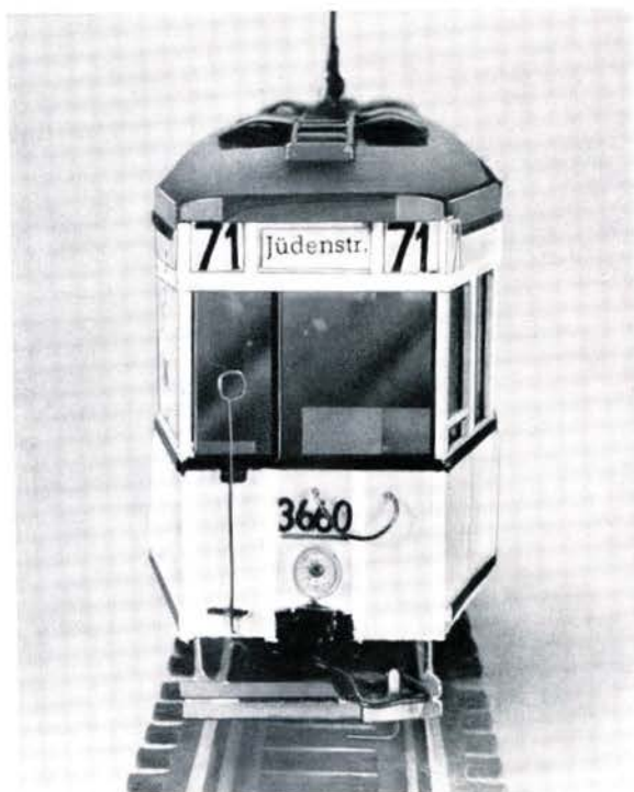
Bild 1 Triebwagen der Linie 71, Typ TM 31 U, Baujahr 1899/1901, Umbau 1931/1932, Länge des Wagenkastens 11 m, Breite 2,20 m, Achsstand 3,20 m, Motoren 2 × 40 kW
