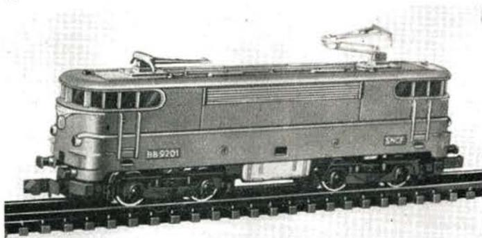
Bild 10 Arnold-N-Modell der elektrischen Lokomotive BB 9200 der Französischen Staatsbahn; Stirnbeleuchtung wechselt mit Fahrrichtung; Masse 110 g; Länge über Puffer 100 mm
