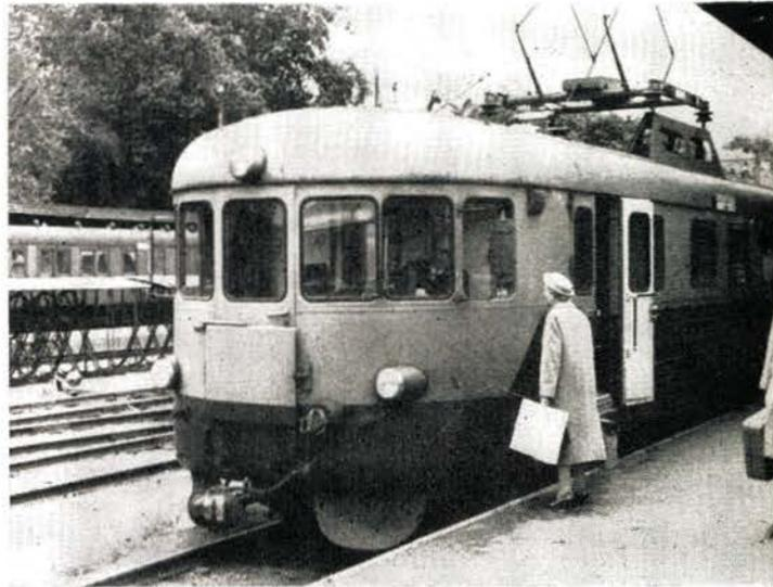
Bild 3 Elektrischer Schienenbus, 15 000 V, 16 2/3 Hz, der TGOJ
