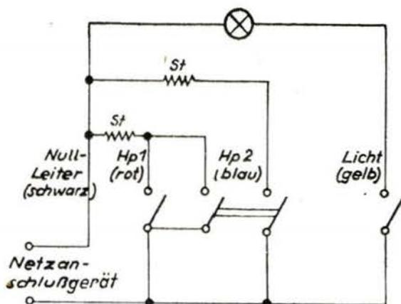
Bild 3 Schaltung für das zweiflügelige Hauptsignal; St Stellmagnet
