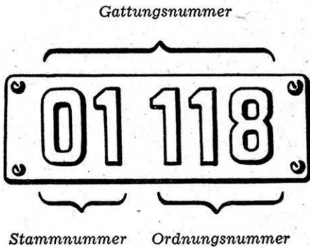
Ähnlich wie elektrische Lokomotiven werden auch elektrische Triebwagen nach Gattungen unterschieden. Vor der Gattungsnummer tragen Triebwagen die Buchstaben
