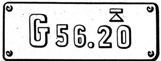
Die Lok hat demnach 5 angetriebene Achsen mit je 20 t Achsdruck. Das Reibungsgewicht beträgt somit (5 · 20) 100 t. Da die Reibung zwischen Rad und Schiene ungefähr  $\frac{1}{5}$  des Reibungsgewichtes beträgt, ergibt die Rechnung (100 : 5) 20 t oder 20 000 kg Zughaftergewicht, d. h., die Lokomotive ist imstande, ein
