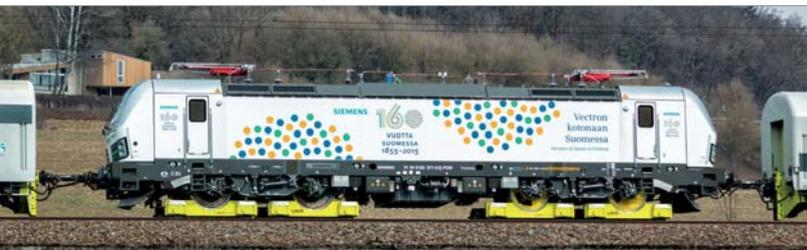
Es muss nicht immer der Lkw sein. Auch Lokomotiven mit inkompatiblen Spurweiten können auf der Schiene überführt werden.
