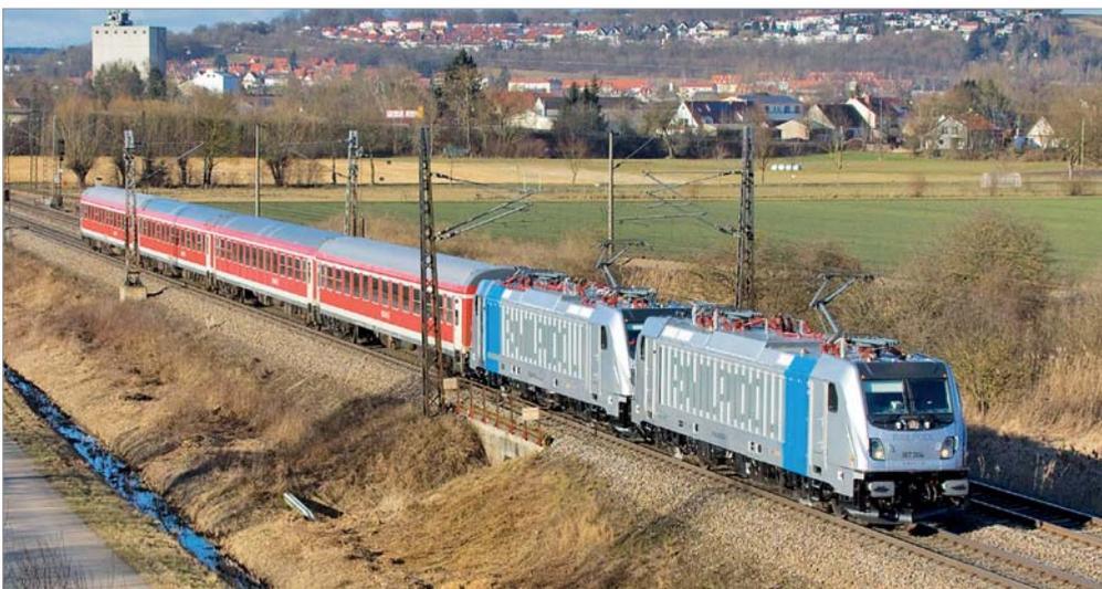
■ In der siebten Kalenderwoche absolvierten 187 004 und 005 (Bombardier-„Last Mile“-Lok) Anhubmessfahrten zwischen Donauwörth und Augsburg. In unterschiedlichen Zugzusammenstellungen wurden sowohl bei Doppeltraktion, im Sandwichbetrieb mit je einer Lok an beiden Zugenden und in Einzeltraktion das Verhalten der Stromabnehmer am Fahrdrabt sowie deren Anpressdruck untersucht. Als Brems- beziehungsweise Zwischenwagen fanden bis zu fünf angemietete Bimz von DB Regio Verwendung.
