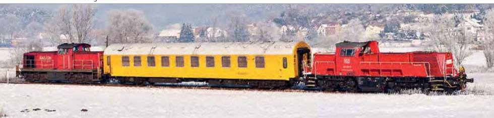
Mit einem Funkmesswagen wurden am 31. Januar 2012 GSM-R-Abnahmefahrten auf den KBS 560 und 559 zwischen Göschwitz und Pößneck unternommen. Bespannt war der Messzug mit 261 022 und 290 505. Auf dem Bild ist der Messzug auf der KBS 559 hinter Orlamünde bei Längenorla unterwegs nach Pößneck unterer Bahnhof.
