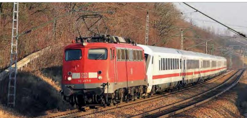
■ **Bügel falte im IC-Einsatz:** Am 31. Januar 2012 brachte 110457 den IC2344 Dresden Hbf – Oldenburg bis nach Leipzig Hbf. Aufgenommen wurde das Foto in der Nähe von Oberau an der Strecke Dresden – Berlin. Da die 110 keine geeignete Wendzugsteuerung besitzt, wurde sie vor den Steuerwagen gespannt.
