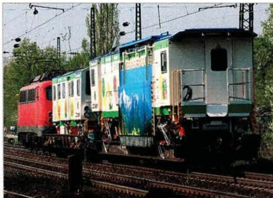
Verladen wurden die beiden Teile auf einem Transportwagen der Ökombi-Gesellschaft für die Rollende Landstraße und einem der seltenen sechsachsigen Transportwagen der Bauart Uaais755, der für Schienenfahrzeuge bis 60t Gewicht ausgelegt ist.
