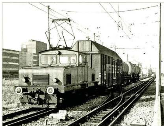
Lok 2 im Betriebseinsatz: Man beachte das Dreischienengleis.
