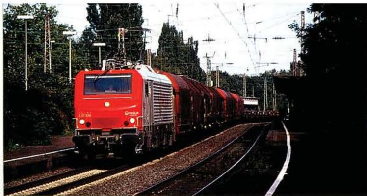
Im September fanden Versuchsfahrten der Dortmunder Eisenbahn mit Prima-Loks vor Stahlzügen im Ruhrgebiet statt. Dank einer so möglichen Erhöhung der Grenzlast auf 2600 gegenüber 1700 Tonnen bisher könnten zwei Zugpaare täglich eingespart werden.
