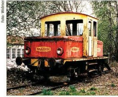
Der Achsstand des Traktors beträgt 2,90 Meter und die Länge 6,50 Meter. Er wurde von den Firmen MFO und SIG gebaut.
