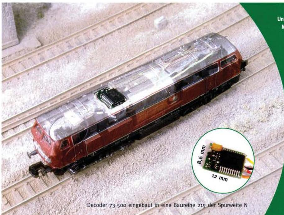
Decoder 73 500 eingebaut in eine Baureihe 215 der Spurweite N
