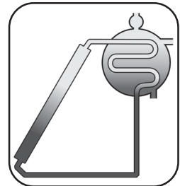
Схема циркуляции холодной и горячей воды в солнечном коллекторе
