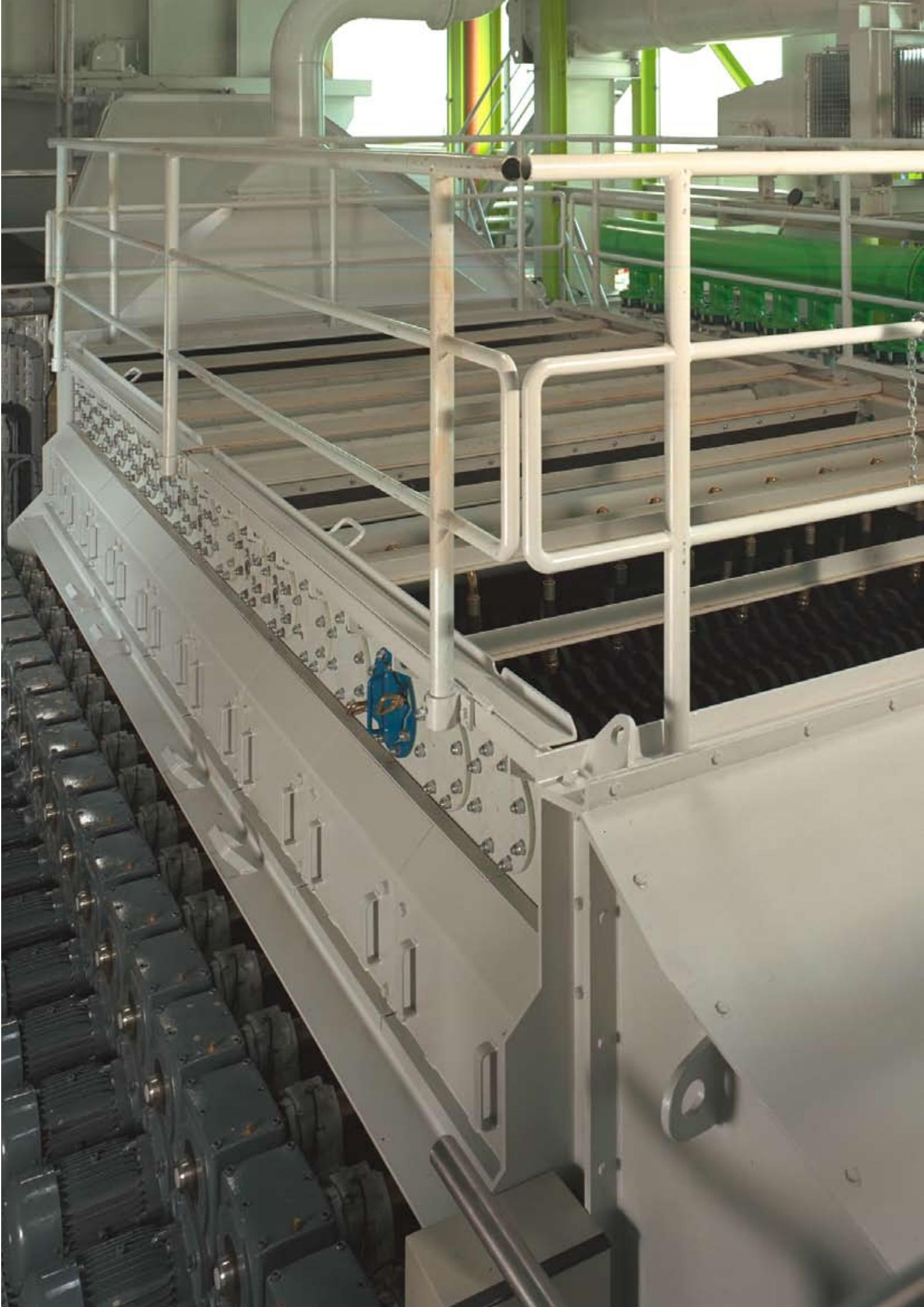
Die Waschwellen sind mittels Stehlagern auf dem Grundrahmen montiert. Die Seitenabdichtung erfolgt durch Spezialdichtringe mit doppelten Dichtlippen.
