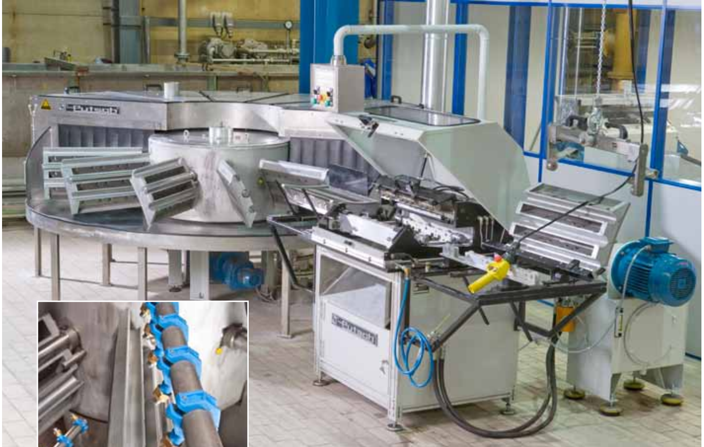
Putsch® Messerkasten-Bestückungsautomat MBA 2200 in Kombination mit dem Putsch® Messerkasten-Waschautomat MWA 2200 Putsch® Automatic Knife Block Assembler MBA 2200 in combination with the Putsch® Automatic Knife Block Washer MWA 2200 Dispositivo Automático de Montaje de Portacuchillas - MBA 2200 de Putsch® en combinación con el Dispositivo Automático de Lavado de Portacuchillas - MWA 2200 de Putsch®
