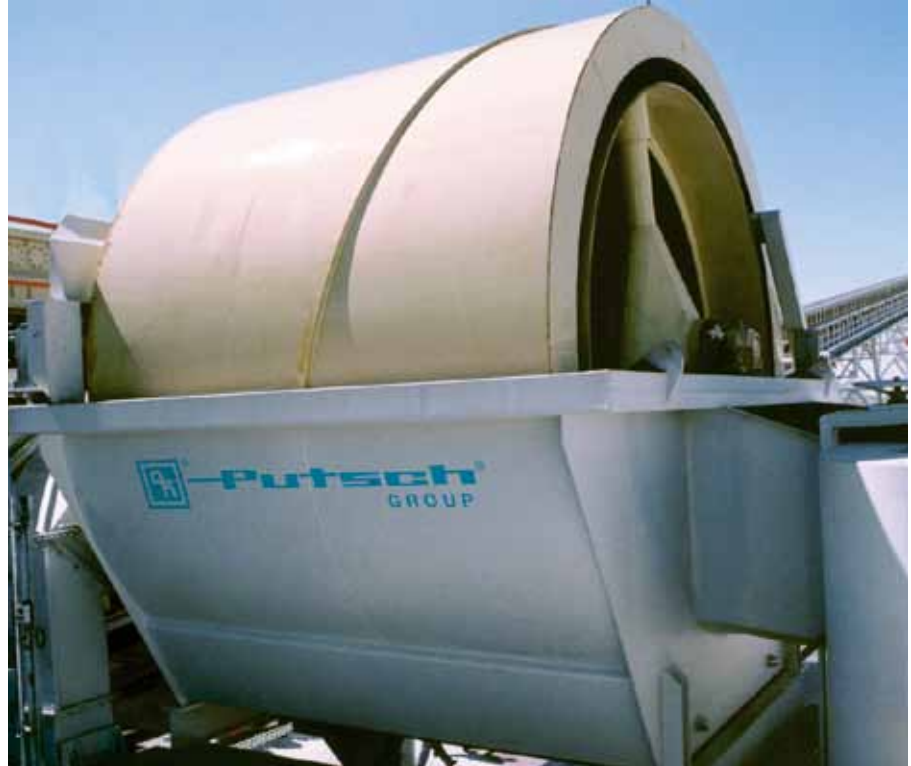
Kies- und Sandaustrag Séparation des sables et graviers Выгрузка гравия и песка
