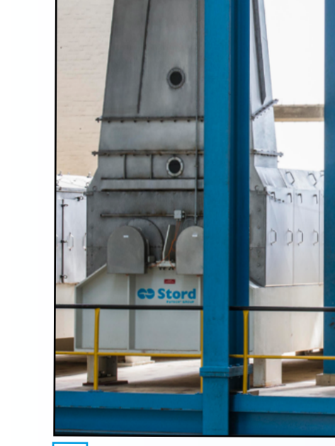
34 Stord Twin Screw Presses / Presse à double vis Stord / Prensa Stord de doble tornillo
