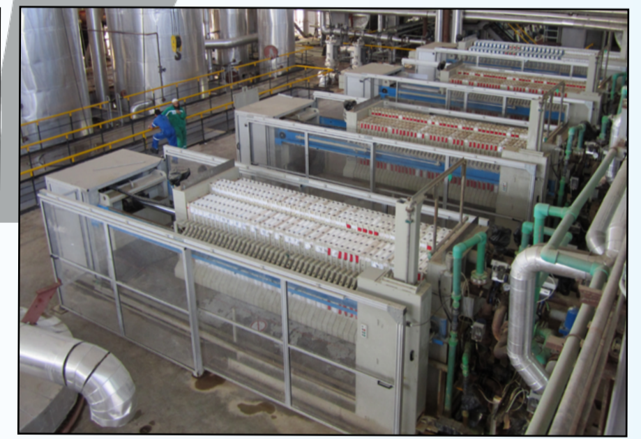
28 Membrane Filter Press PKF / Filtre-pressé à membranes PKF / Filtro prensa de membrana PKF
