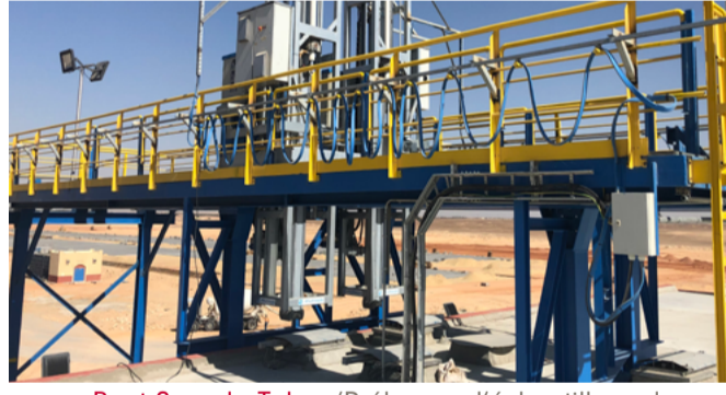
1 Beet Sample Taker / Prélèveur d'échantillons de betteraves / Tomador de muestras de remolacha
