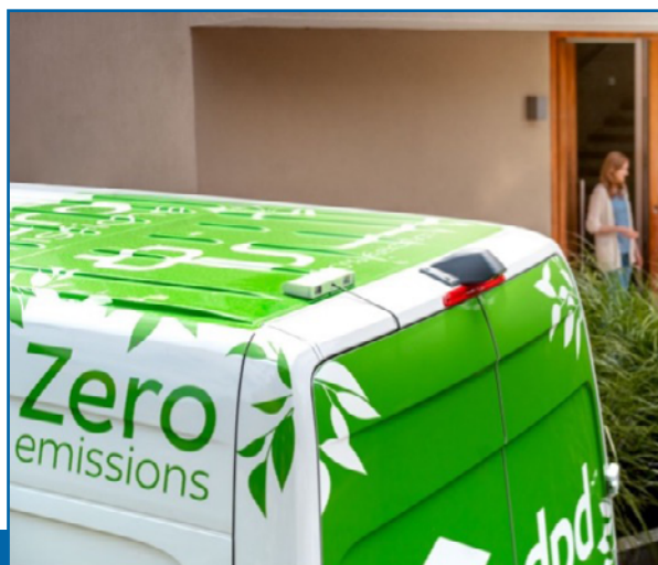
figure 2.2 : capteur Pollutrack sur le toit d'un véhicule.
