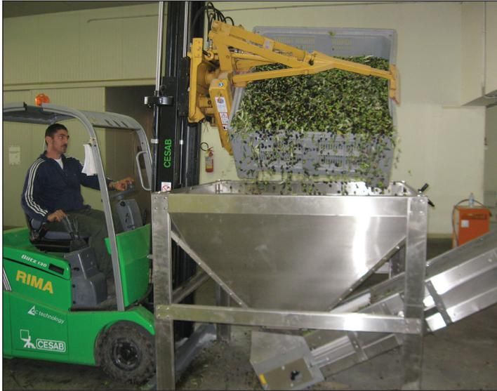
Figura 3.22 – Scarico delle olive dal cassone nella tramoggia mediante muletto.
