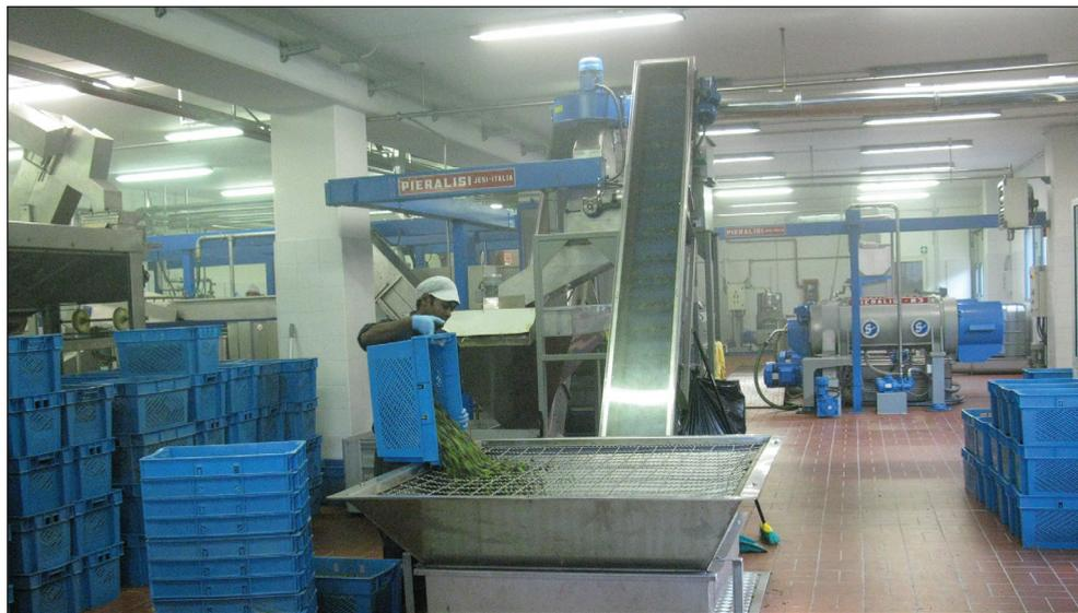
Figura 3.18 – Scarico manuale delle olive nella tramoggia per avviarle alle operazioni di defogliazione e lavaggio.
