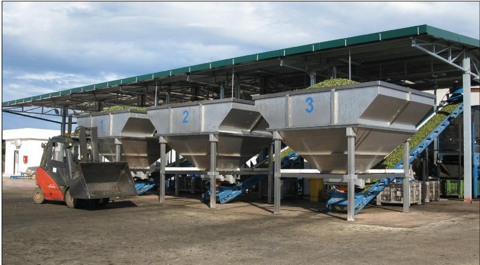
Figura 3.26 – Stoccaggio delle olive in grosse tramogge in un oleificio pugliese di grandi dimensioni (dicembre 2012).
