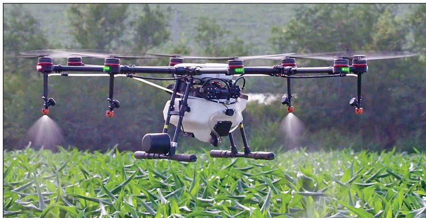
**Fig. 1.2** | Un drone (APR) a 8 rotori equipaggiato per l'irrorazione.
